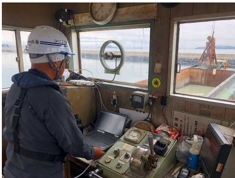
ブリッジ室PCによる遠隔監視
