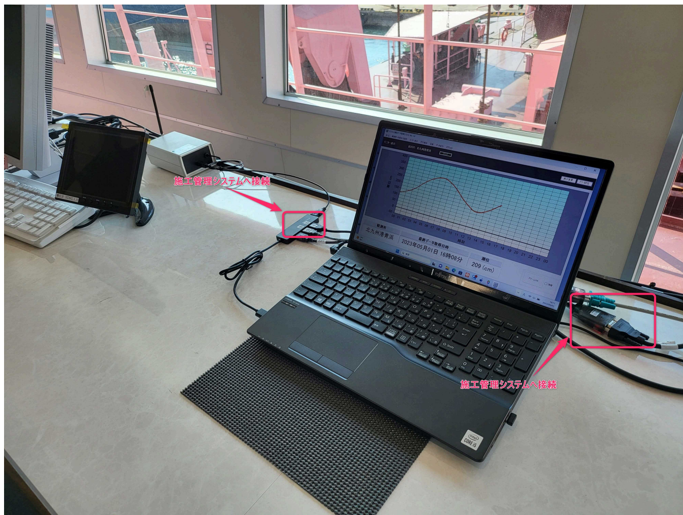
ナウファス潮位データ収集・送信システム設置概要
